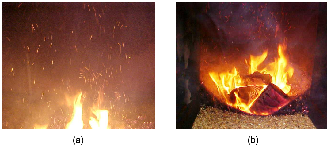
Figura 37. Combustão da lenha associada à palha de café: (a) queima das partículas menores em suspensão e (b) acúmulo das partículas maiores na região da grelha.
