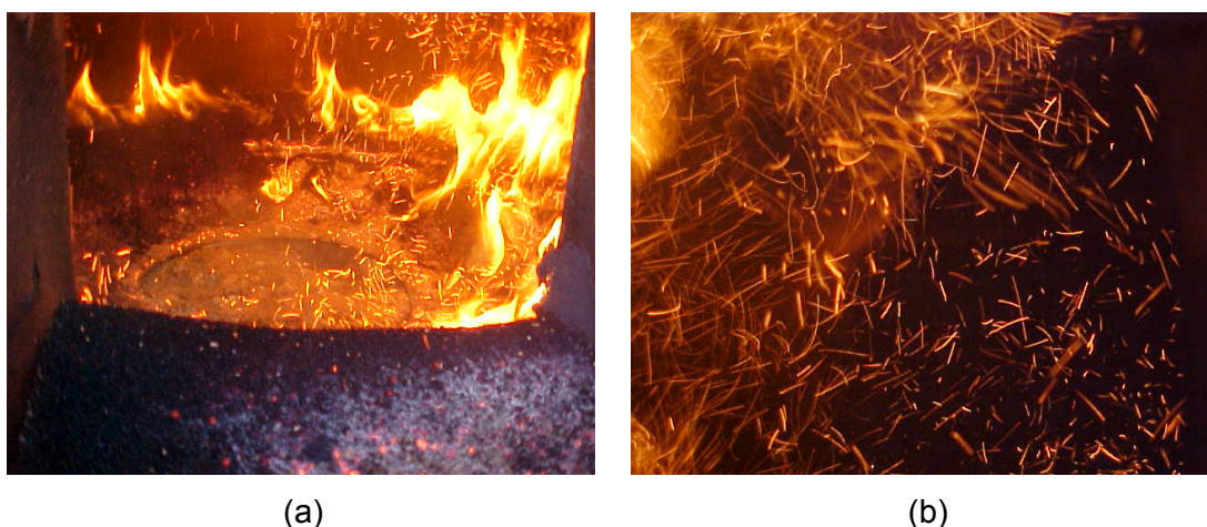
Figura 46. (a) chama piloto e (b) partículas de serragem queimando em suspensão.
