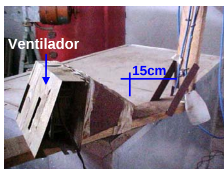
Figura 16. Psicrômetro não-aspirado desenvolvido.
