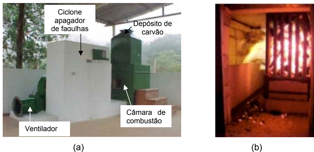
Figura 3. Fornalha a carvão vegetal com aquecimento direto do ar: (a) Vista geral da fornalha e (b) Carvão em combustão na grelha (LOPES, 2002).
