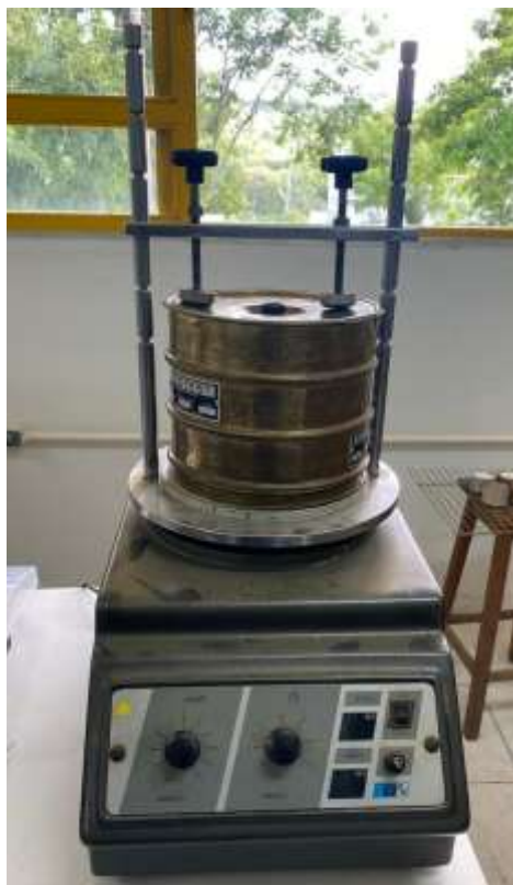
Figura 7 – Peneirador mecânico utilizado no experimento. Fonte: Autor (2025).
