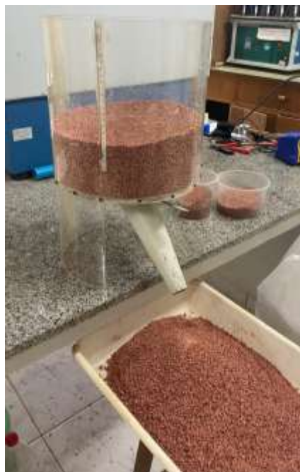
Figura 6 – Dispositivo utilizado para medição de ângulo de repouso dos fertilizantes. Fonte: Autor (2025).
