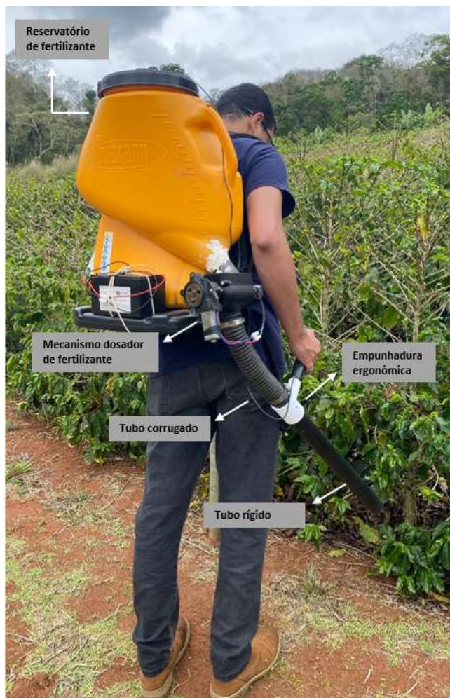
Figura 5 – Adubadora costal para aplicação pontual de fertilizantes granulados. Fonte: Autor (2025).
