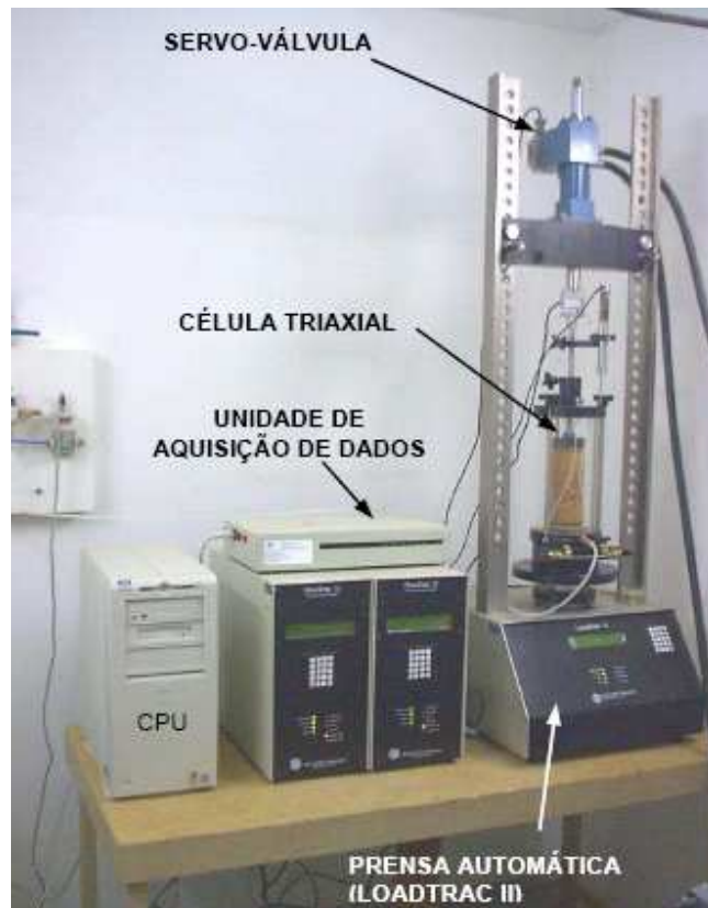
Figura 3.8: Vista geral do equipamento triaxial dinâmico da UFV.
