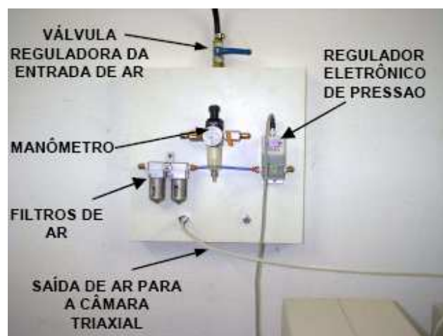
Figura 3.9: Detalhe do quadro de controle de aplicação das tensões de confinamento.
