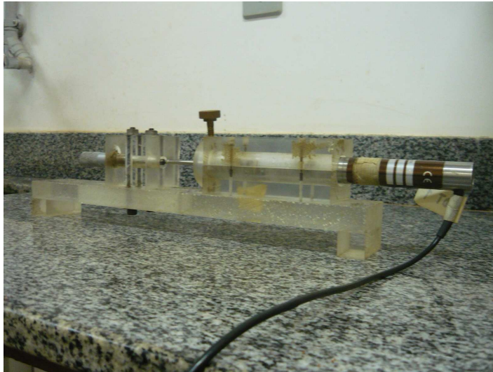
Figura B.1: LVDT instalado no micrômetro para execução das calibrações.
