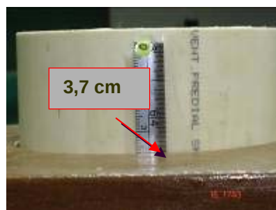
FIGURA 7 – Esquema dos gasômetros: vista externa dos gasômetros (a) e régua graduada no gasômetro para a leitura (b).
