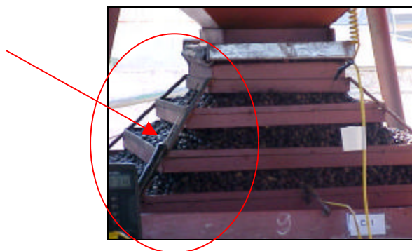
Figura 16 - Sonda termoeletrica para medição da temperatura do ar de exaustão.
