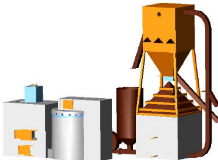
Figura 34 - Nova estrutura do secador com sistema pneumático para café,
