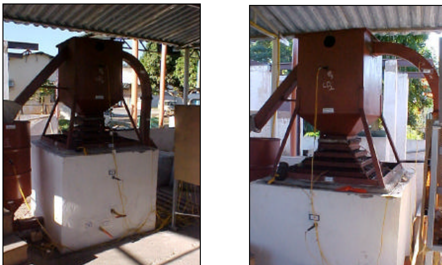
Figura 15 - Vista do secador para café com sistema pneumático e sistema de aquisição de dados (sondas termoeletricas).
