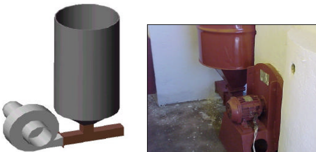
Figura 19 - Detalhe do ventilador acoplado à tubulação de transporte.
