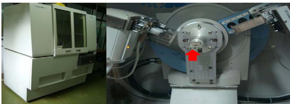
Figura 4: Demonstração do teste de difração de RX em difratômetro; A) Difratômetro da marca PANalytical modelo X'Pert Pro; B) Região interna do difratômetro no momento da leitura do material contido na lâmina de vidro posicionada no centro do leitor (seta).
