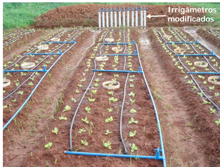
Figura 7 – Minilímetros conectados aos irrigômetros modificados no ambiente não protegido.
