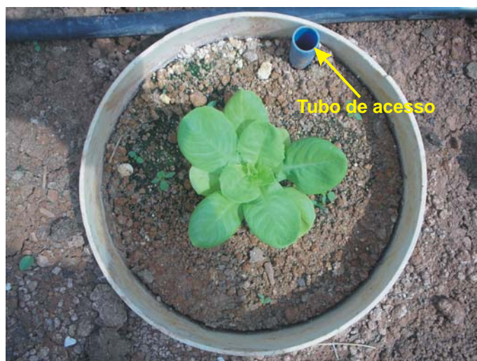
Figura 8 – Tubo de acesso instalado dentro do minilímetro usado na leitura do lençol freático e na sucção da água excedente.
