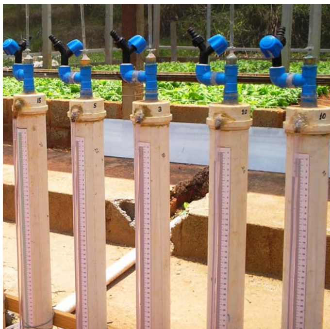
Figura 10 – Irrigômetros modificados equipados com a escala laminar graduada.
