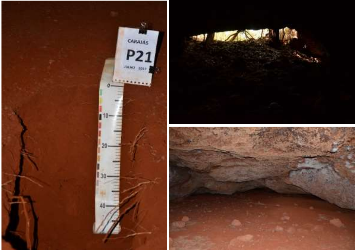
Figura 47. A esquerda perfil de PLINTOSSOLO PÉTRICO Concrecionário latossólico, com raízes abundantes ao longo de toda a seção de controle. No canto superior direito visão do perfil para fora da cavidade, e no canto inferior direito visão do local de coleta no interior da cavidade.
