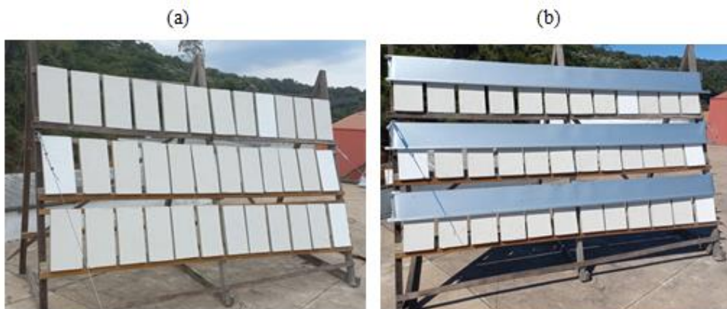
Figura 3.7 – Amostras de tinta expostas para o ensaio de resistência ao intemperismo natural: a) antes da fixação da chapa metálica; b) após a fixação da chapa metálica.
