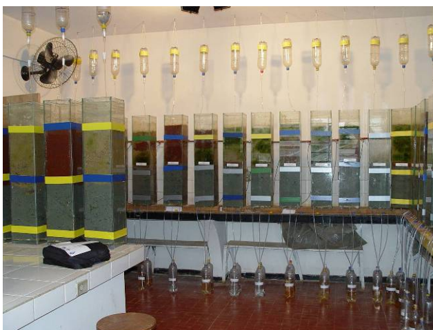
Fotografia 1. Lisímetros com sistema de aplicação de água e coleta de lixiviado.
