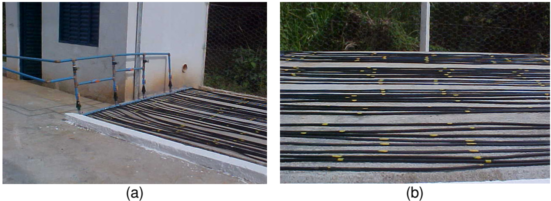
Figura 6 - Bancada experimental com as quatro unidades de fertirrigação (a) e a marcação dos gotejadores nas linhas laterais (b).
