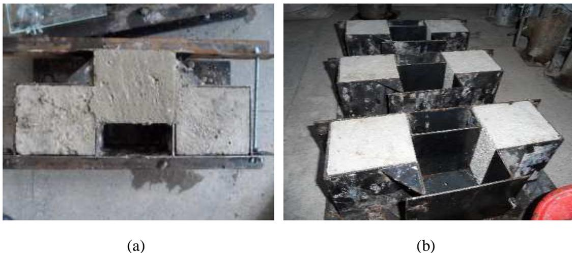
Figura 3.25 - Aspecto da moldagem do corpo de prova composto de três prismas para o ensaio de resistência de aderência ao cisalhamento direto.
