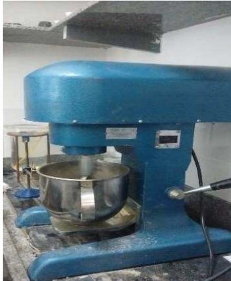
Figura 3.7 - Argamassadeira de eixo vertical utilizada para produção do CPR.
