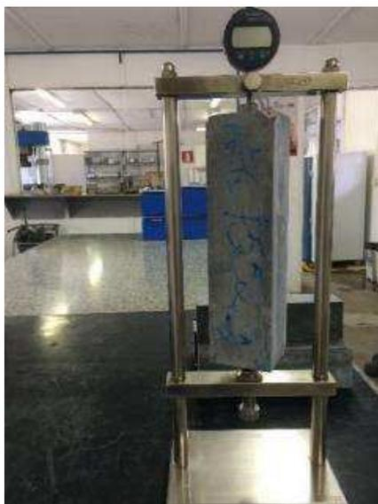
Figura 3.16 - Aspecto geral do ensaio de compatibilidade dimensional.
