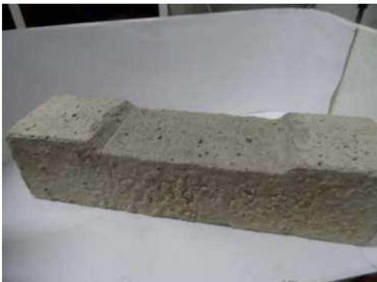
Figura 3.18 - Aspecto geral da superfície de um corpo de prova antes da aplicação do material de reparação.
