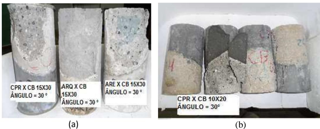
Figura 4.12 - Aspecto de ruptura monolítica de corpos de prova cilíndricos reparados.
