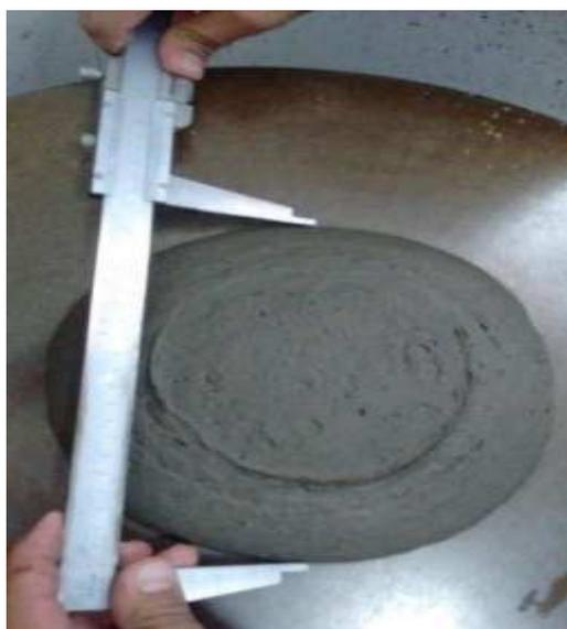
Figura 3.11 - Aspecto do ensaio de consistência (*flow table*) para o CPR e argamassas.
