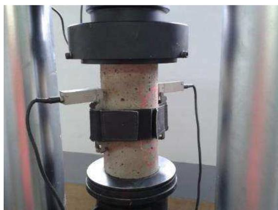
Figura 3.14 - Aspecto do ensaio de determinação do módulo de elasticidade do concreto e argamassas.
