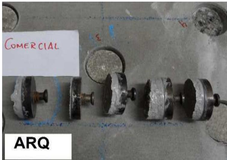
Figura 4.20 - Aspectos dos corpo de prova de ARQ após o ensaio de aderência a tração.
