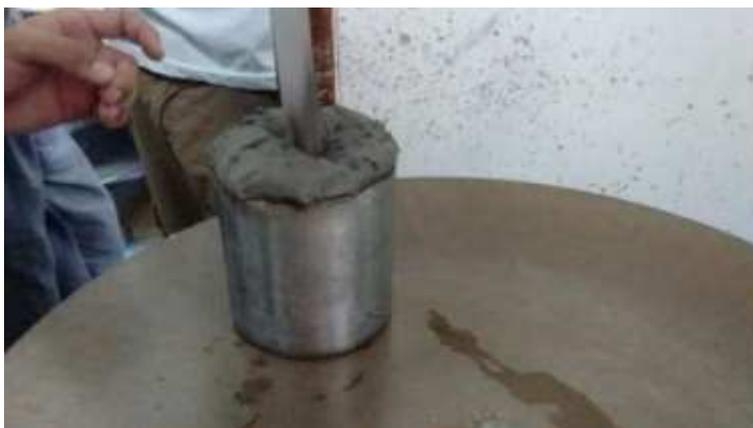
Figura 3.12 - Aspecto do ensaio de determinação da densidade e do teor de ar incorporado do CPR e das argamassas.
