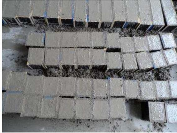
Figura 3.6 - Moldagem dos corpos de prova de concreto base.
