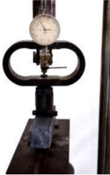
Figura 3.17 - Aspecto do ensaio de resistência à tração na flexão.
