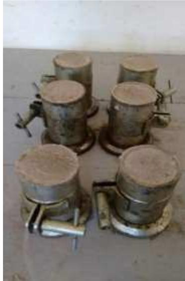
Figura 3.9 - Corpos de prova de argamassa.
