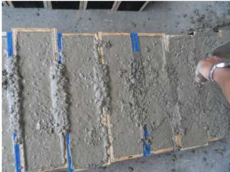
Figura 3.19 - Preparação do corpo de prova para o ensaio de reconstituição do prisma.
