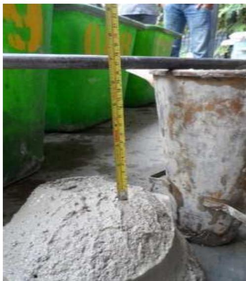
Figura 3.10 - Aspecto do ensaio de abatimento do tronco de cone (*slump test*) para o concreto base.
