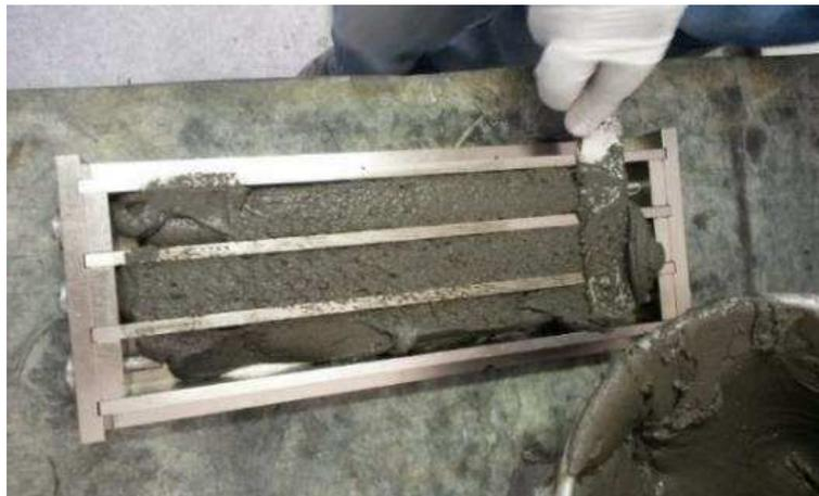
Figura 3.15 - Moldagem dos corpos de prova para o ensaio de compatibilidade dimensional.
