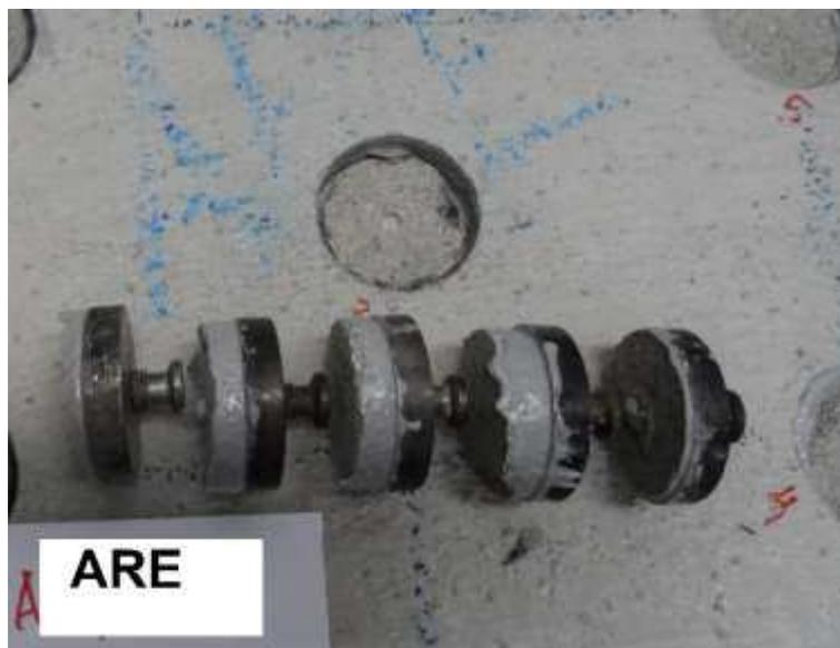
Figura 4.21- Aspectos dos corpo de prova de ARE após o ensaio de aderência a tração.
