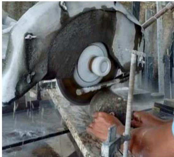
Figura 3.21 - Corte do corpo de prova para o ensaio de reconstituição do cilindro.
