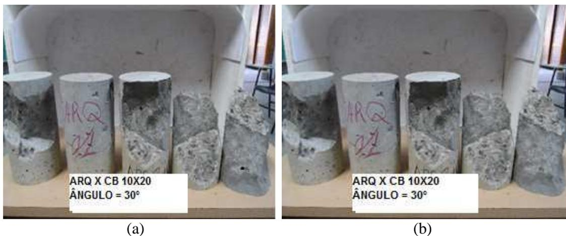
Figura 4.14 - Aspecto da ruptura monolítica de um corpo de prova:
