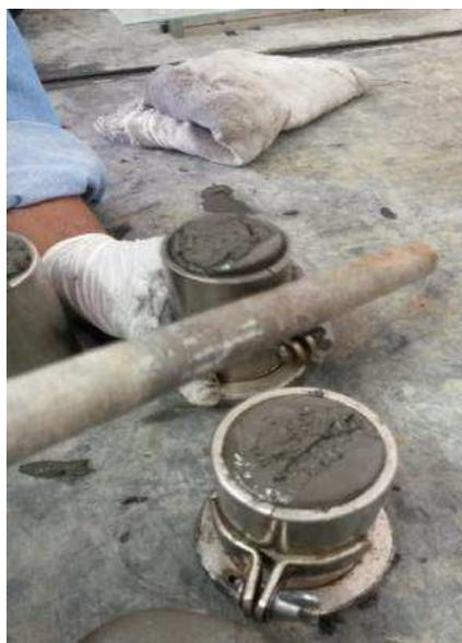
Figura 3.8 - Moldagem dos corpos de prova de CPR.
