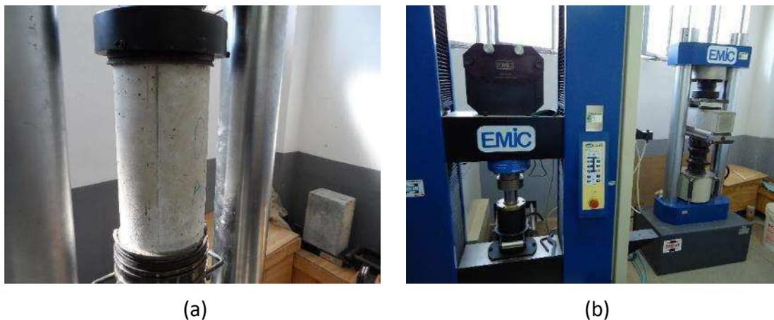
Figura 3.13 - Ensaio para determinação da resistência à compressão: (a) detalhe do corpo de prova; (b) detalhe da máquina de ensaio.
