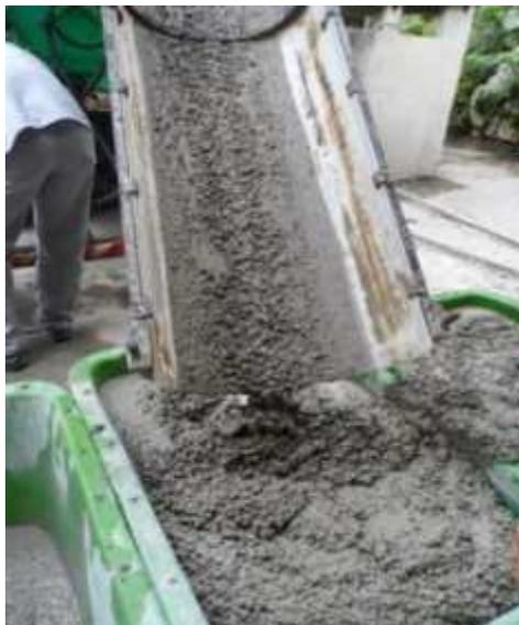
Figura 3.5 - Coleta do concreto base para moldagem dos corpos de prova.
