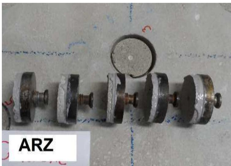
Figura 4.22 - Aspectos dos corpos de prova de ARZ após o ensaio de aderência a tração.
