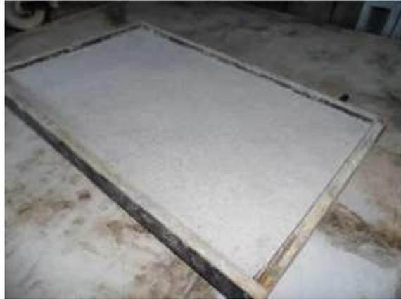
Figura 3.27 - Placa de concreto base para produção dos corpos de prova para o ensaio de resistência de aderência à tração.
