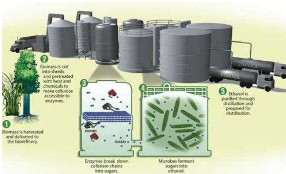
Figura 1: Da biomassa ao etanol celulósico. Em destaque, algumas etapas fundamentais da produção em grande escala de etanol celulósico (2G) (US DOE, 2007).
