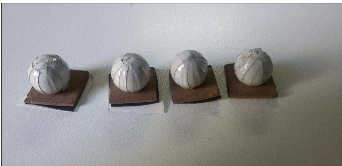
Figura 12. Marcadores confeccionados a partir de esferas de polipropileno e película retrorreflexiva, fixados à base flexível de polipropileno.
