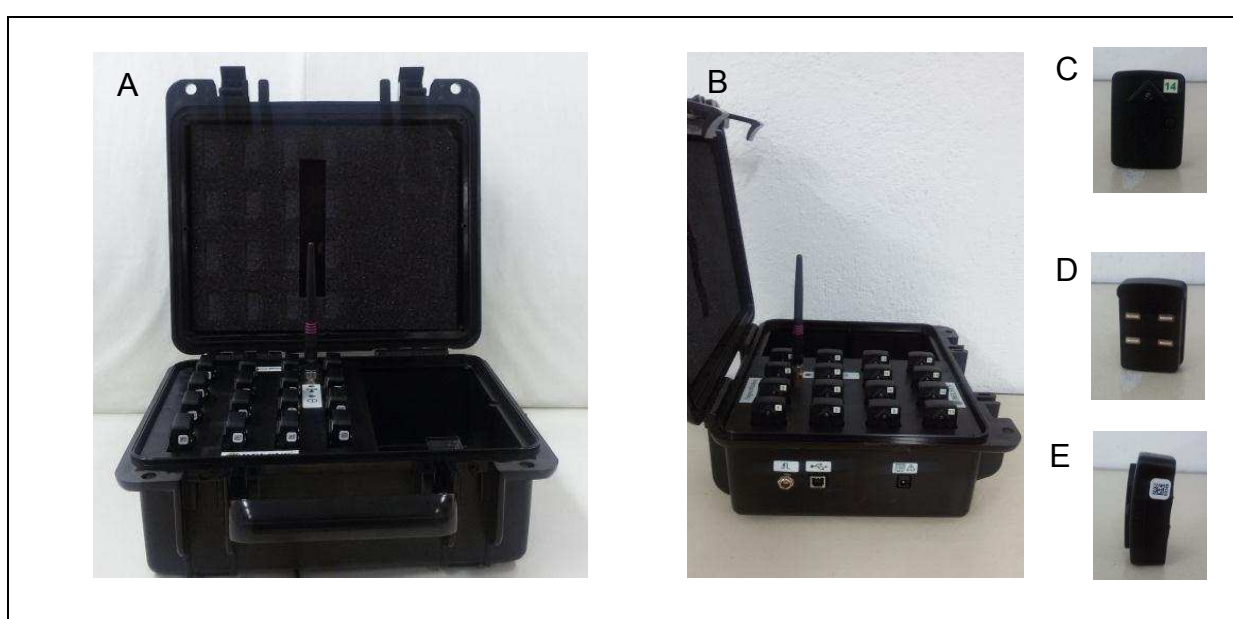
Figura 15: Sistema de eletromiografia wireless Trigno®. Visão geral do equipamento (A e B) e detalhe dos sensores (C, D e E).
