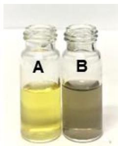
Figura 17. Suspensões de NPs Ag. (A) Suspensão de NPs Ag estáveis. (B) Suspensão de NPs Ag agregadas.
