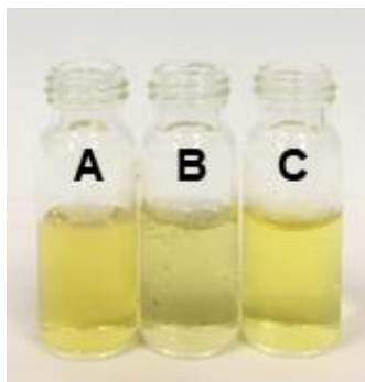
Figura 26. Suspensões de NPsAg sintetizadas com monitoramento por análise condutimétrica. (A) AC-NPAg-1 (sem controle de temperatura – dia 1); (B) AC-NPAg-2 (com controle de temperatura – dia 1); (C) AC-NPAg-3 (com controle de temperatura – dia 2).
