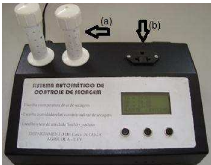
Figura 38 - Parte frontal do sistema de controle para bomba de calor
