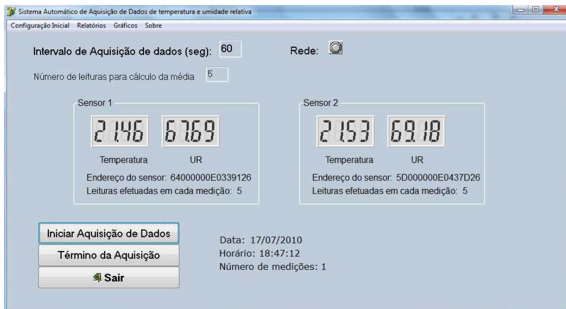
Figura 44 - Sistema de aquisição de dados 1-wire para dois pares de sensores
