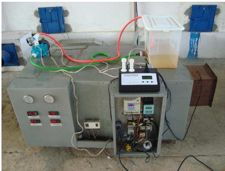
Figura 41 – Protótipo do sistema de controle e sistema de borrifamento de água acoplados à bomba de calor
