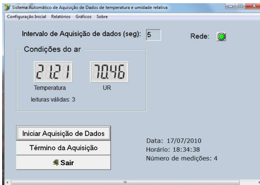
Figura 43 - Sistema de aquisição de dados 1-wire para um par de sensores
