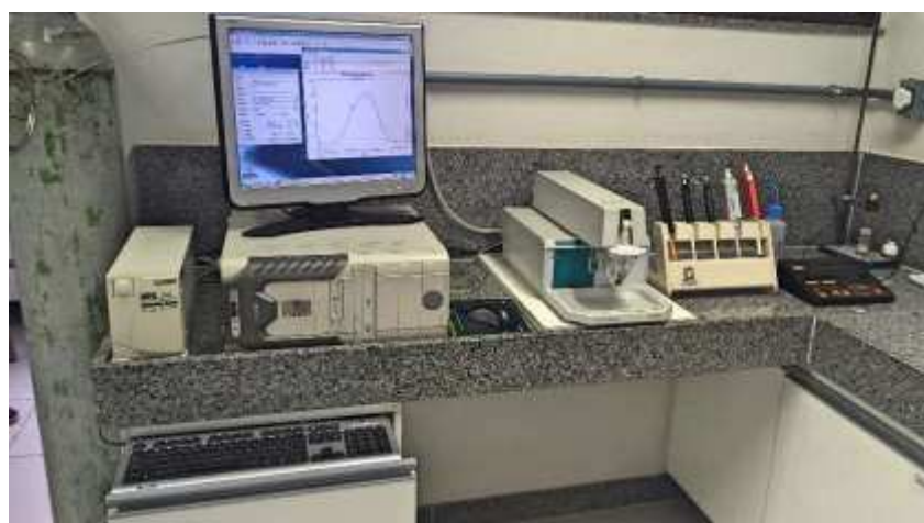
Figura 10. (A) Cella voltamétrica (B) Analisador voltamétrico da Metrohm modelo 797 VA Computrace
