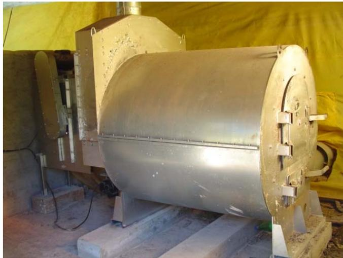
Figura 7 – Fornalha a lenha com queima indireta do ar utilizada no experimento
