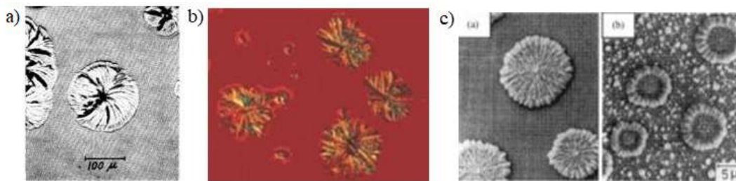
Figura 4.13 - (a) cristalização de selênio, (b) esferulites com diâmetro de ~ 0.1 mm sobre a superfície de um filme a-Se (c). Imagens de microscopia eletrônica.
