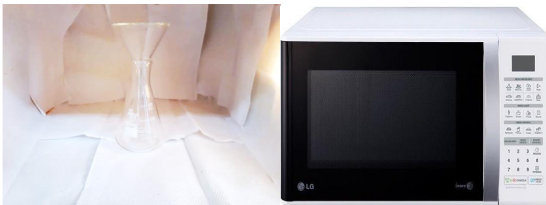
Figura 2.19 – Aparato experimental e aparelho de micro-ondas doméstico utilizado na condução de reações multicomponentes para o preparo de acridino-1,8-dionas.
