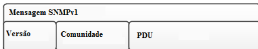
Figura 2.6 - Estrutura de pacote SNMPv1 [STEENKAMP, 2012]
