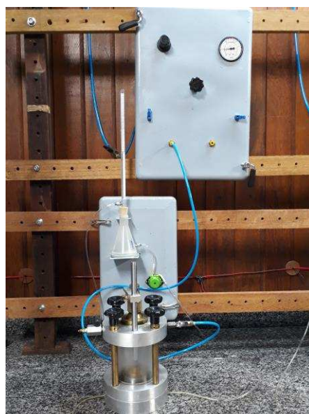
Figura 29 – Detalhe dos novos painéis de fibra de vidro para controle de pressão, medidores de volume e circulação de água.
