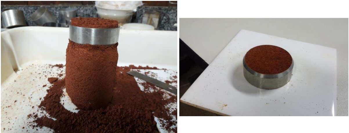
Figura 22 – Moldagem de um corpo de prova da Amostra 1.
