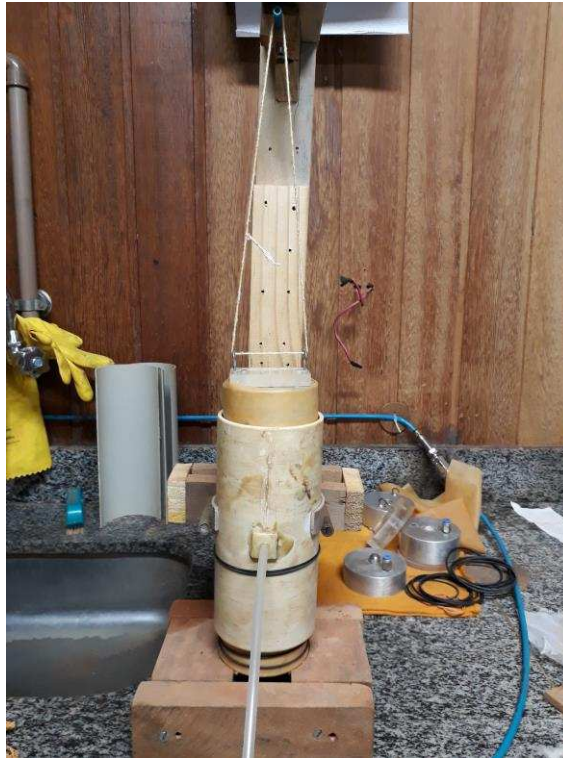
Figura 18 – Tudo de PVC erguido pelo suporte de madeira, com a membrana de latex presa ac top cap e ao disco por oringues.
