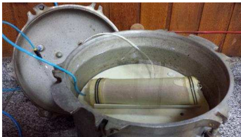
Figura 20 – Amostra dentro da câmara de compressão hidrostática com a base conectada ao topo por uma mangueira permitindo a drenagem.
