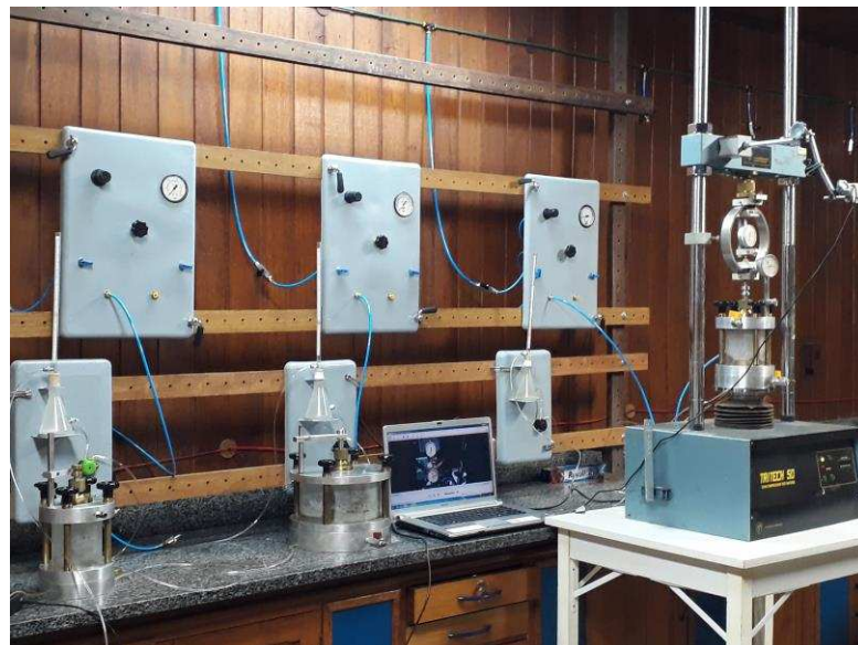
Figura 29 – Detalhe dos novos painéis de fibra de vidro para controle de pressão, medidores de volume e circulação de água.
