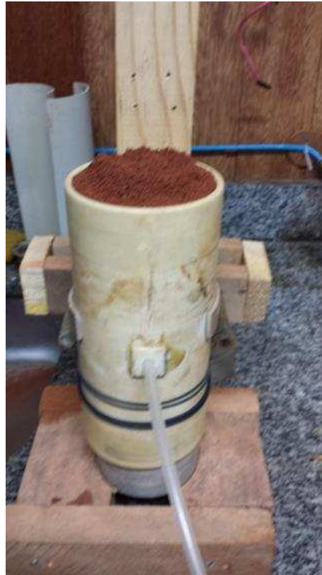
Figura 17 – Solo depositado no molde de PVC.
