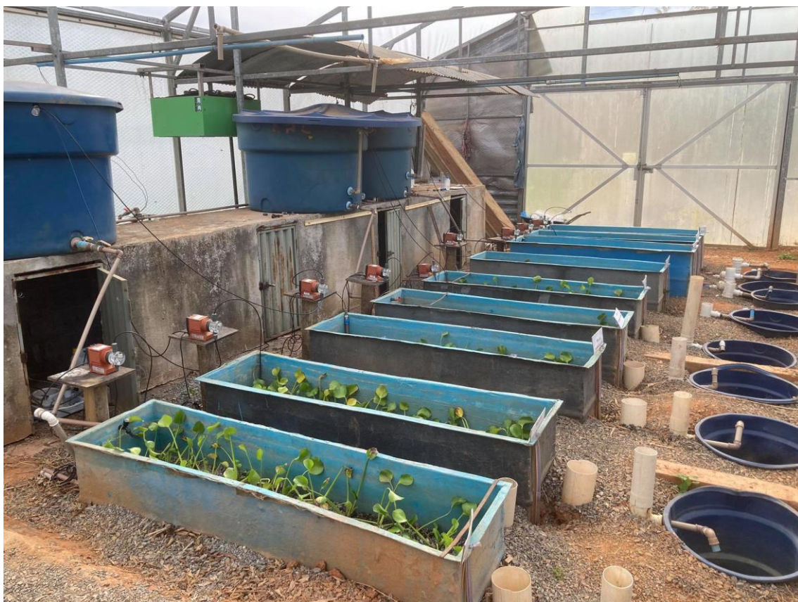
Figura 4.1 - Disposição das Wetlands Construídas com detalhes das caixas de abastecimento (canto superior esquerdo), bombas dosadoras e caixas coletoras de efluente (canto inferior direito) enterradas no solo. Fonte: do autor.
