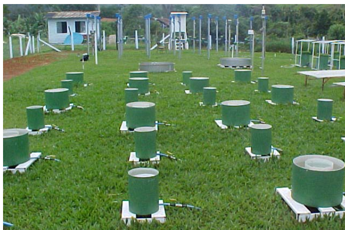
Figura 3 – Minievaporímetros UFV-1 e UFV-2 instalados na Unidade de Pesquisa e Desenvolvimento do Irrigâmetro.
