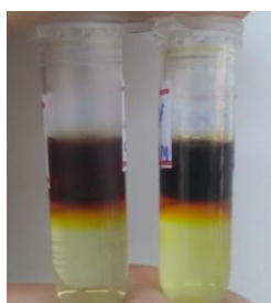
Figura 6. Imagem do sistema bifásico constituído pelo ES TOPO+THY e solução aquosa de solução de ácido nítrico 1,0 mol \text{L}^{-1} (fase superior rica em ES e fase inferior rica em \text{HNO}_3 ).
