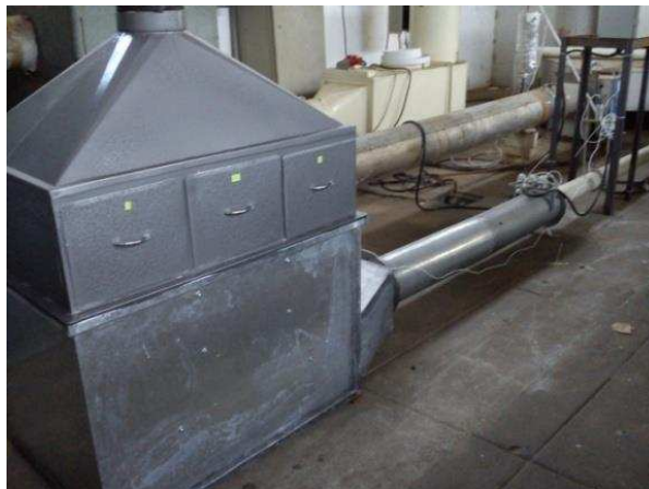
Figura 3 – Secador utilizado na secagem de Erva-baleeira ( Varronia curassavica )
