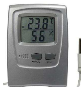
Figura 5- Termo-higrômetro utilizado para registro da temperatura e umidade relativa do ambiente.
