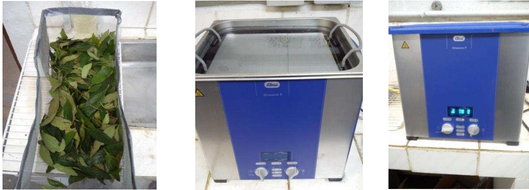
Figura 2- Banho de ultrassom utilizado para realização do pré-tratamento nas amostras de folhas de Varronia curassavica .
