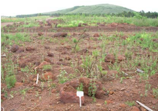
Foto 23. Cobertura vegetal de parcelas com 20 cm de camada de capeamento sem o uso de fertilizantes.
