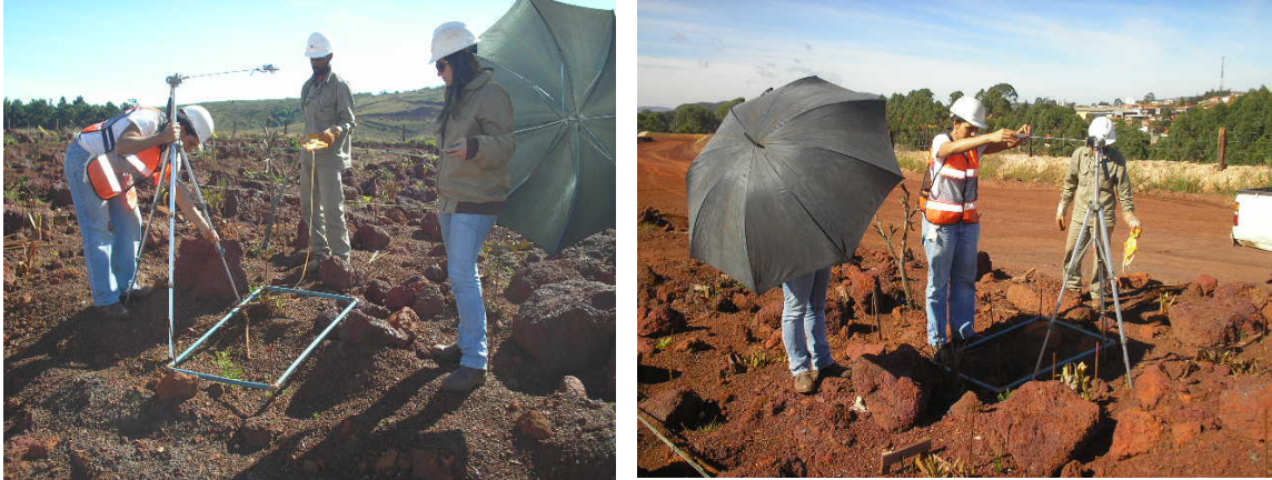
Figura 8 – Posicionamento do tripé adaptado e do quadrante de PVC. Registro fotográfico para quantificação da cobertura vegetal para posterior tratamento das imagens utilizando o programa “QUANT”.
