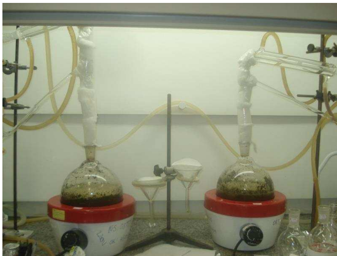
Figura 7. Dos aparatos tipo Clevenger en proceso de hidrodestilación de hojas de C. verbenacea .
