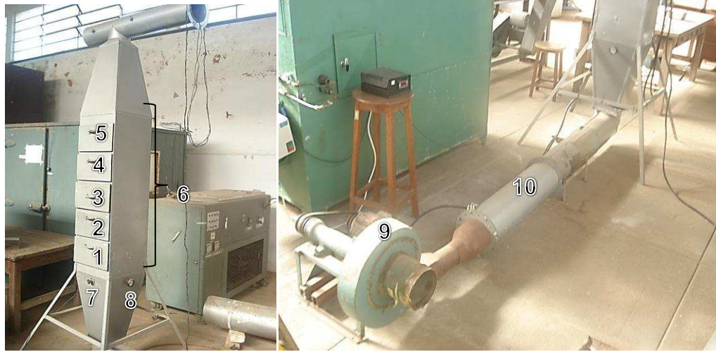
Figura 5. Secador de plantas medicinales: (1, 2, 3, 4, 5) Bandejas. (6) Cámara de secado (conjunto de bandejas). (7) Anemómetro de palas. (8) Termómetro. (9) Ventilador. (10) Ducto de aire de secado con sistema de calentamiento por resistencias eléctricas.
