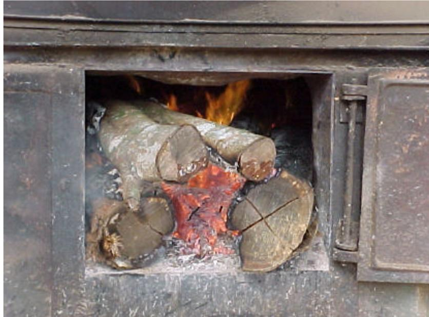
Figura 36 – Vista frontal da combustão da lenha de eucalipto na fornalha a fogo indireto.
