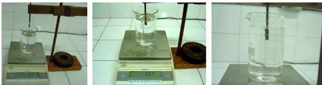
Figura 16 – Determinação do volume da amostra pelo método de imersão.
