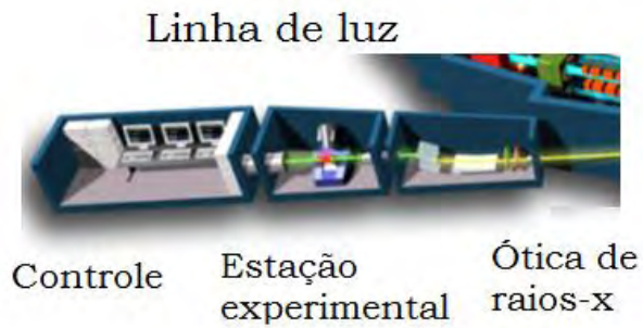
Figura 3.4: Uma linha de luz é constituída por uma ótica de raios-x, uma estação experimental onde se colocam as amostras e um controle para calibrar e operar o sistema.
