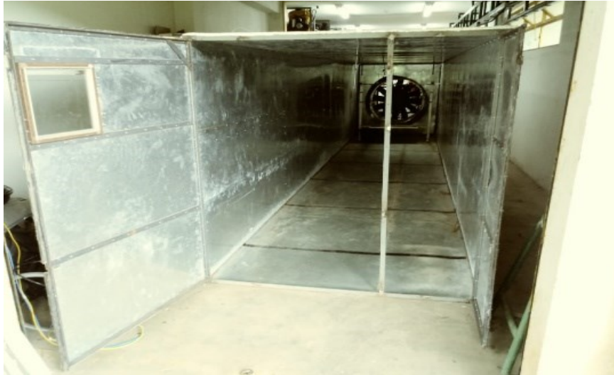
Figura 5 – Vista do túnel de vento para saída do ar durante a pulverização.
