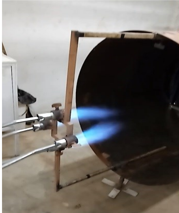
Figura 15 – Lança-chamas para o aquecimento do ar no interior do túnel de vento.
