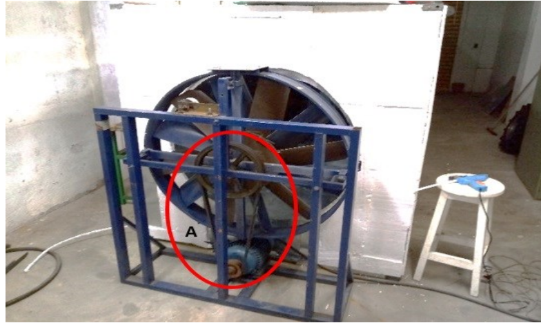
Figura 21 – Sistema de transmissão de potência do ventilador ligado ao motor.
