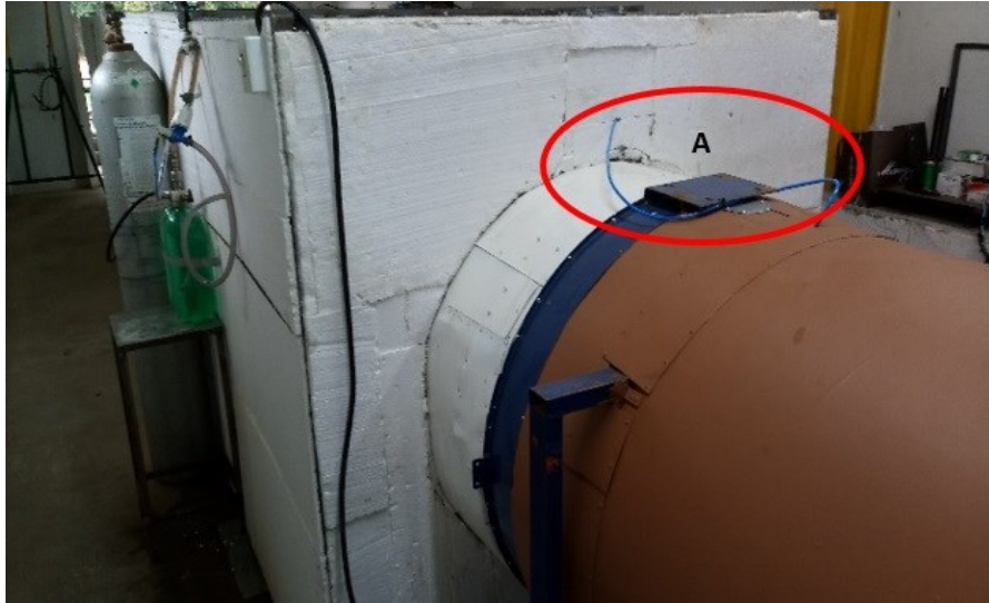
Figura 14 – Sistema de aquecimento conectado ao túnel de vento, com sensor do tipo termopar do tipo K fixado.
