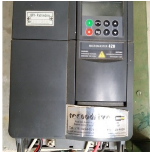
Figura 18 – Inversor de frequência para variação da velocidade angular do eixo do motor.
