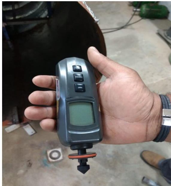
Figura 22 – Tacômetro manual para aferição de rotação.
