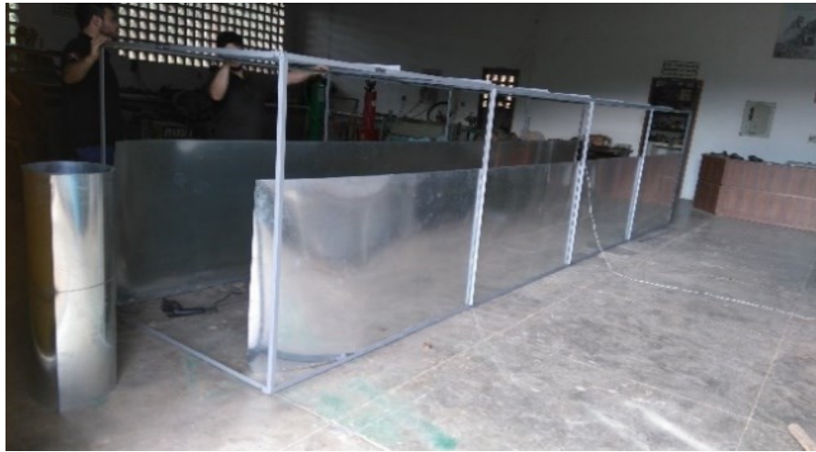
Figura 2 – Montagem do túnel de vento.
