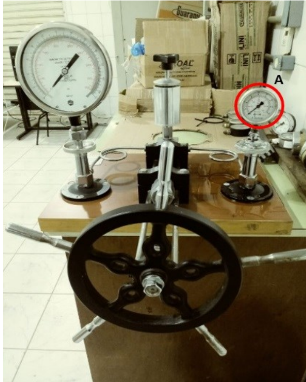
Figura 23 – Bancada de calibração de manômetro, com a presença do manômetro de referência e do manômetro a ser calibrado.
