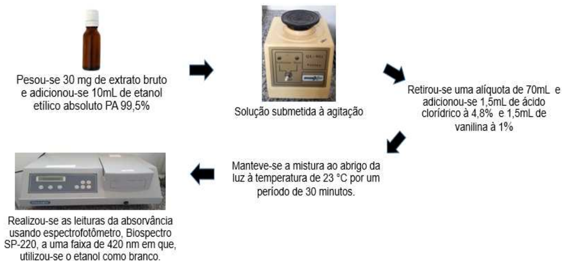
Figura 9 - Esquema da metodologia de quantificação de flavonoides de extrato de folhas de Lippia origanoides secas à 50, 60 e 70 °C (Fonte: Autora).
