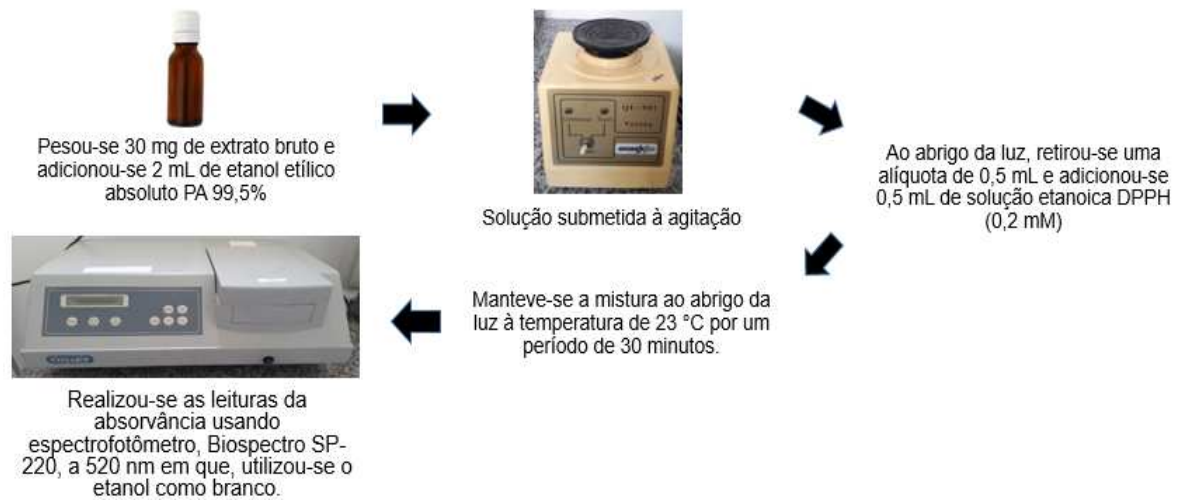
Figura 11 - Esquema da metodologia de determinação da atividade antioxidante dos compostos fenólicos presentes em extratos etanólicos de folhas de Lippia origanoides secas à 50, 60 e 70 °C (Fonte: Autora).
