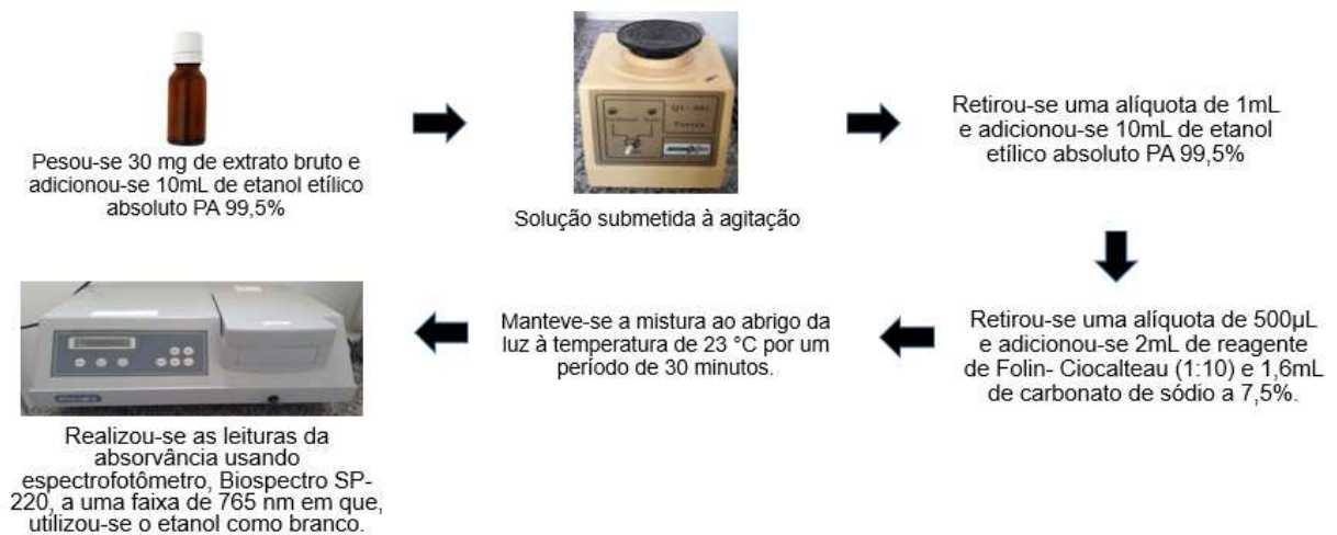
Figura 7 - Esquema da metodologia de quantificação de compostos fenólicos de extrato de folhas de Lippia organoides secas à 50, 60 e 70 °C (Fonte: Autora).
