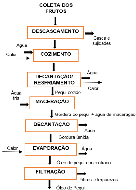
Figura 1.3: Fluxograma do processo artesanal de obtenção do óleo de pequi.
