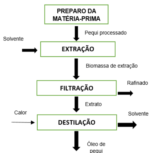
Figura 1.9: Processo de extração sólido-líquido do óleo de pequi.
