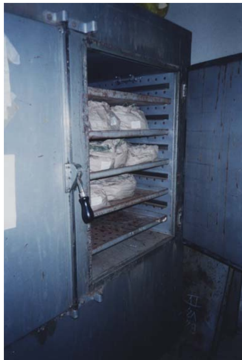
Figura 8A. Pré-secagem da forrageira em estufa a 65°C por 72 h.
