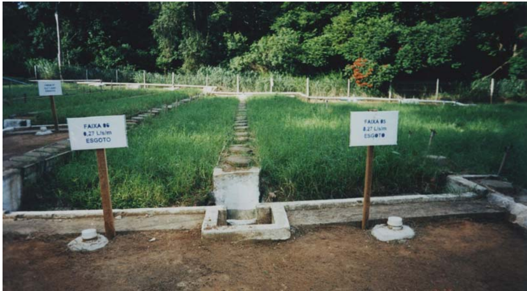
Figura 4A. Rampas de escoamento com 2% de declividade.
