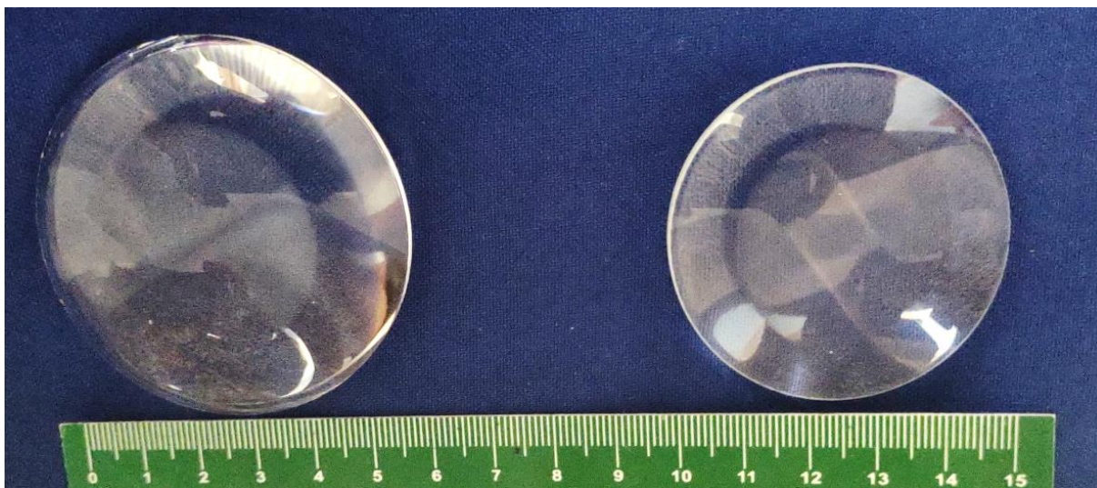
Figura A.1.4 - Lentes convergentes de distância focal de 60 mm e 40 mm, respectivamente.
