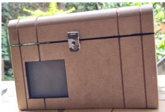
Figura A.1.7 - Caixa baú de madeira em MDF com recorte feito para o anteparo de papel vegetal.
