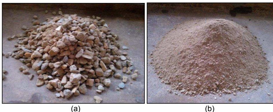
Figura 3-1. Resíduos de construção civil reciclados. (a) brita 1 e (b) areia média.
