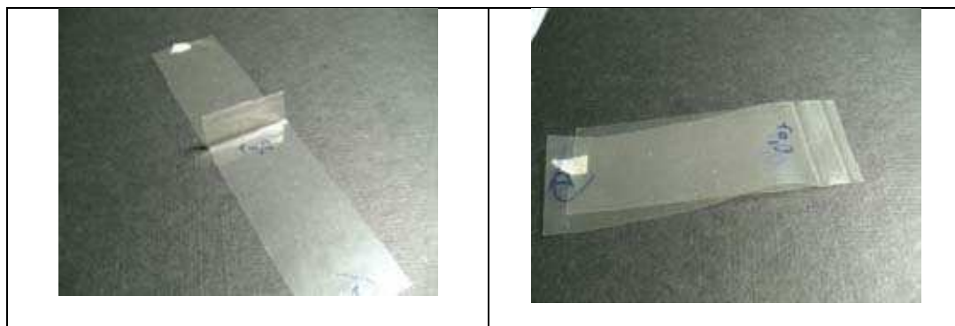
Figura 5. Corpo de prova para teste de resistência da termossoldagem à tração.
