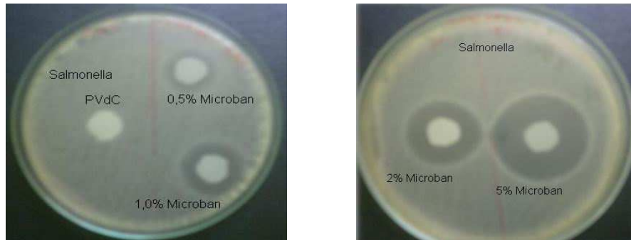
Figura 14. Halo de inibição de filmes de PVdC controle e com 0,5 a 5% de triclosan, frente a Salmonella .
