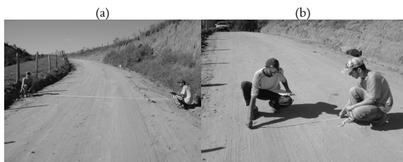
Figura 3. (a) Medição da largura da superfície da estrada; (b) medição dos defeitos de acordo com Eaton et al. (1987a).
