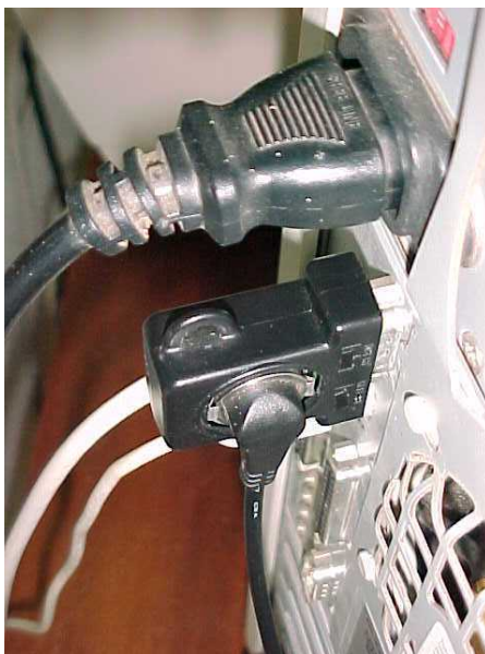
FIGURA 8.9 - Conexão da linha de transmissão de dados 1-wire™ com a porta serial do computador por meio do conector DS1411.
