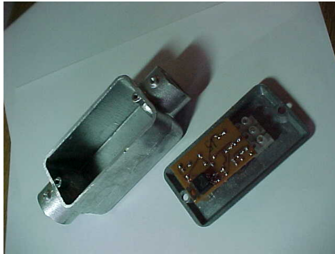
FIGURA 8.6 - Circuito impresso com o sensor de temperatura DS1820 instalado em condutele.
