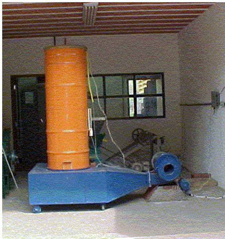
FIGURA 8.10 - O silo protótipo para testes experimentais.
