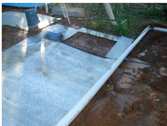
Figura 11. Vista do esquema experimental, mostrando a parcela utilizada em um ensaio e as demais cobertas com chapa metálica.
