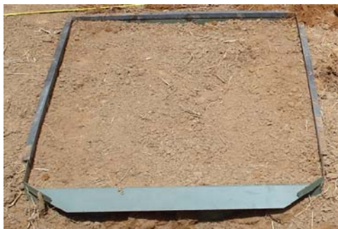
Figura 8. Vista da parcela experimental, delimitada por chapas metálicas enterradas 0,15 m no solo.
