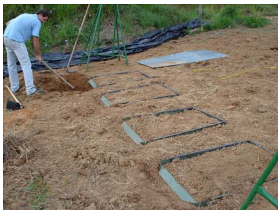
Figura 10. Vista da disposição das parcelas experimentais sob o simulador de chuvas.
