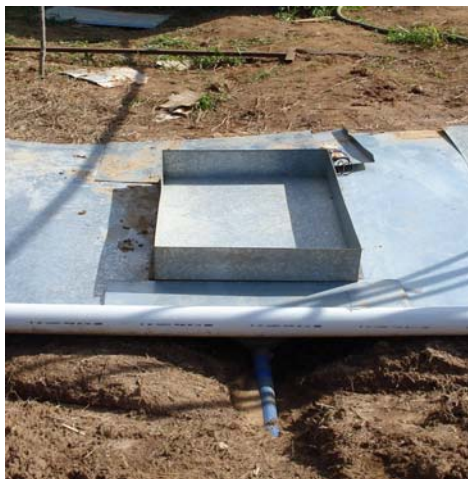
Figura 12. Calha utilizada para determinação da intensidade de precipitação aplicada durante o teste experimental.
