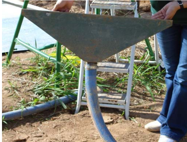
Figura 13. Vista da calha de coleta utilizada para o direcionamento do escoamento superficial ao recipiente de coleta.
