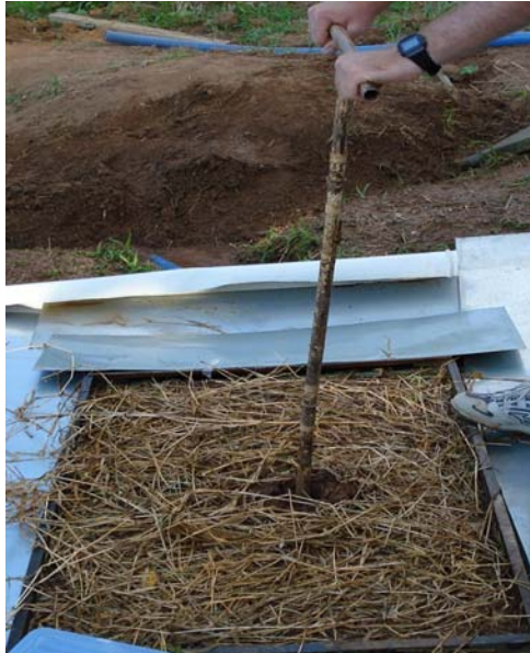
Figura 16. Retirada de amostra do solo ao final do teste para determinação do teor de água.
