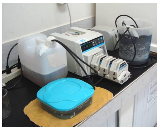
Figura 6 – Biorreator a membranas adaptado para o experimento.
