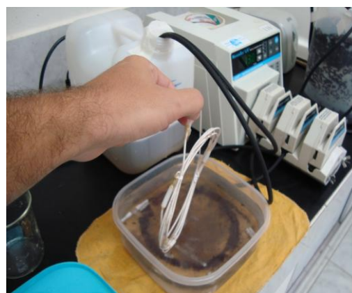
Figura 7 – Detalhe do módulo de membrana adaptado para escala de bancada.
