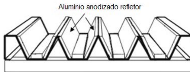
Figura 1.3 - Refletor de alta refletividade montado nas paredes do concentrador tipo V.
