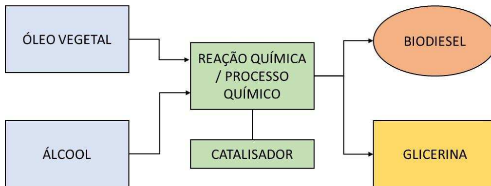
Figura 3.1- Representação esquemática do processo de produção de biodiesel. Fonte: Própria
