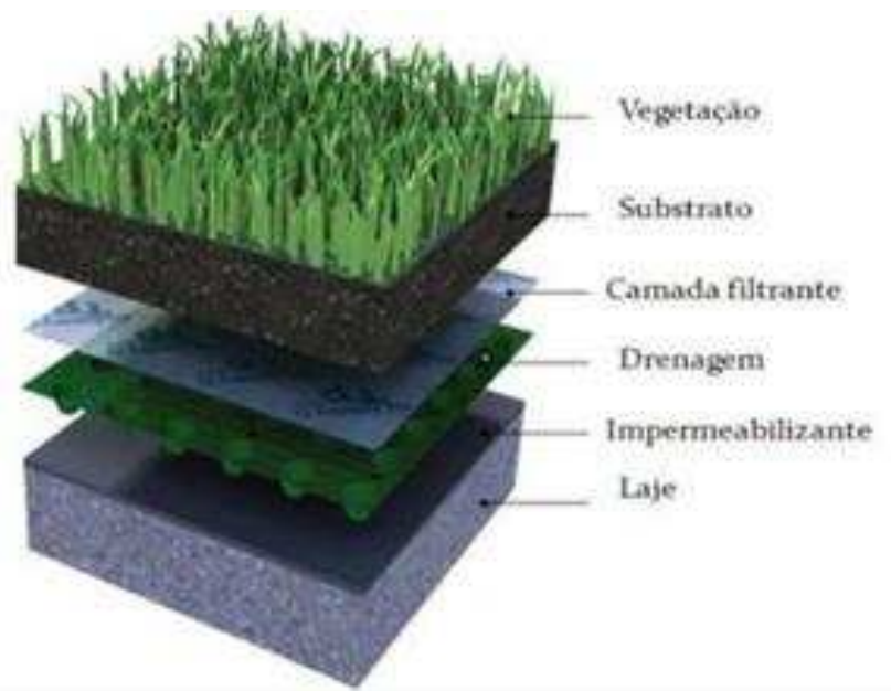
Figura 5 - Corte esquemático de componentes de telhado verde
