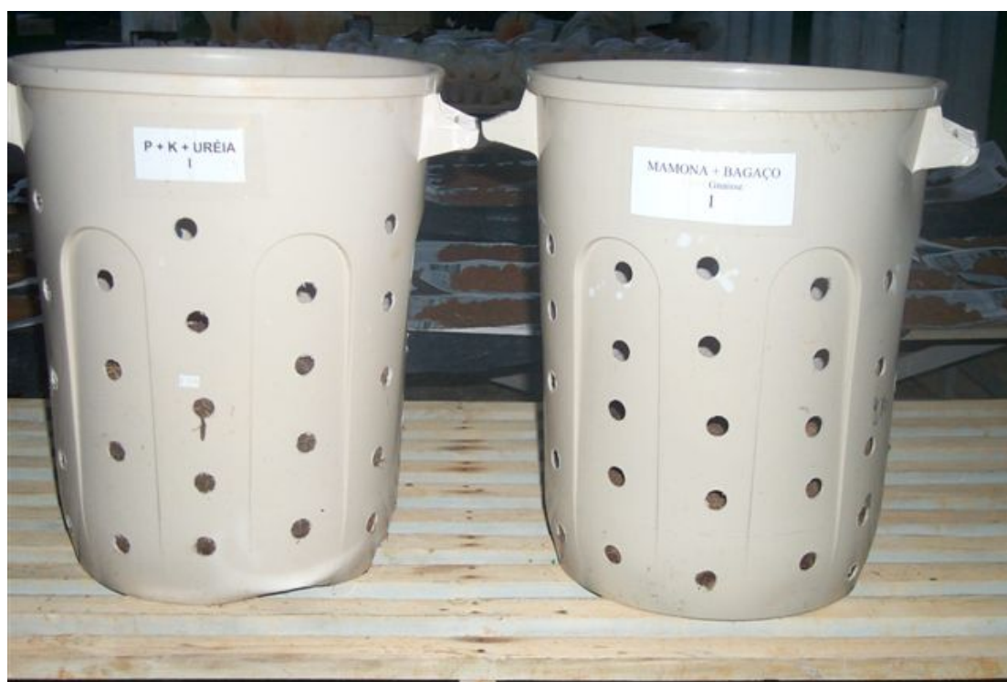
Figura 2. Recipiente de 60 L com perfurações laterais utilizados para acondicionamento de misturas de materiais orgânicos para obtenção dos compostos orgânicos.
