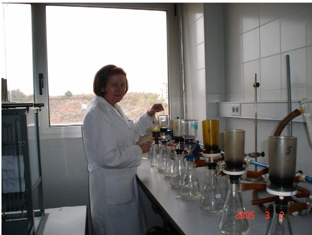
Figura 22. Disposição de tubos de percolação integrados, com sistema a vácuo, para determinação da capacidade de troca catiônica de compostos orgânicos com diferentes materiais e enriquecimentos minerais.
