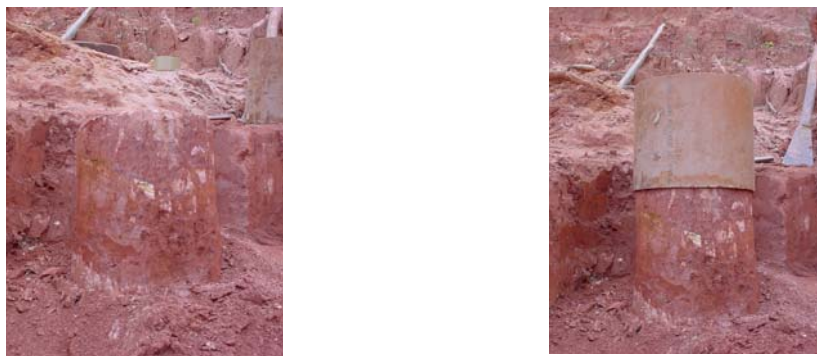
Figura 4.2: Detalhe da coleta de amostra indeformada no campo.
