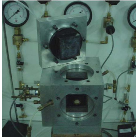
Figura 3.3: Visão geral do quadro de reação da célula triaxial cúbica.
