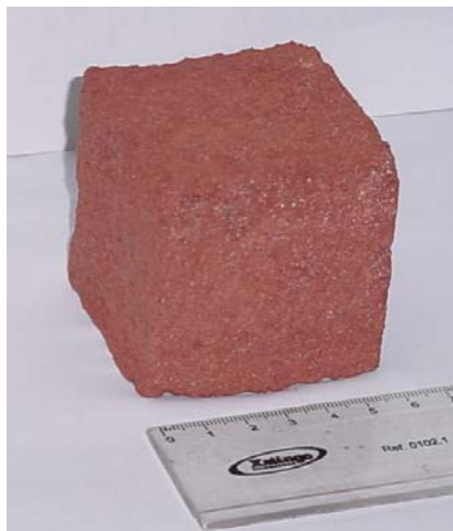
Figura 4.4: Detalhe da amostra moldada em formato cúbico com 6 cm de lado.
