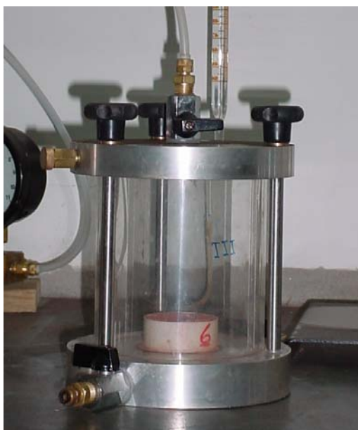
Figura 4.14: Anel colocado na câmara de pressão.
