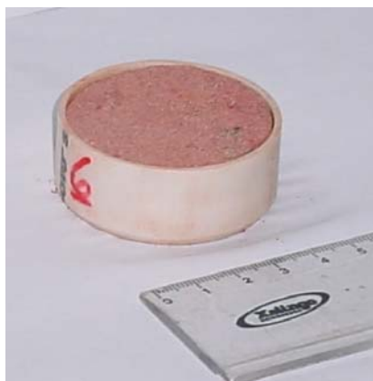
Figura 4.7: Detalhe da amostra moldada em formato cilíndrico.
