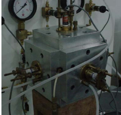
Figura 4.9: Detalhe da célula triaxial cúbica com todas as faces colocadas.
