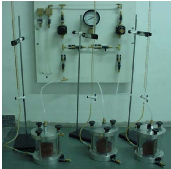
Figura 3.14: Vista das câmaras de pressão para instalar a sucção.
