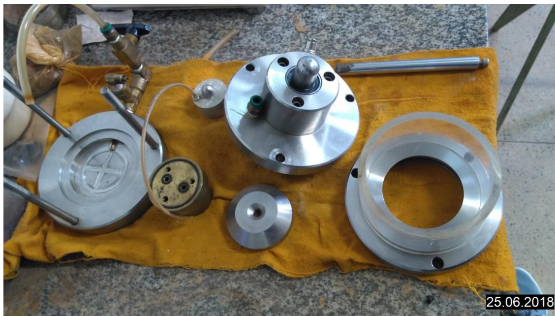
FIGURA 16: Componentes da célula do ensaio CRS
