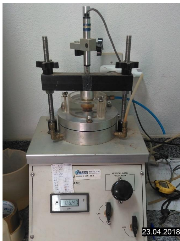
FIGURA 11: Prensa para ensaio de adensamento incremental.
