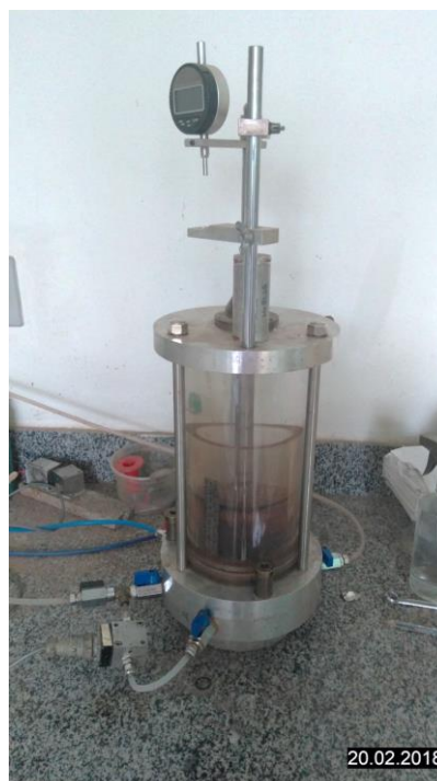
FIGURA 5: Câmara triaxial e transdutor de poropressão
