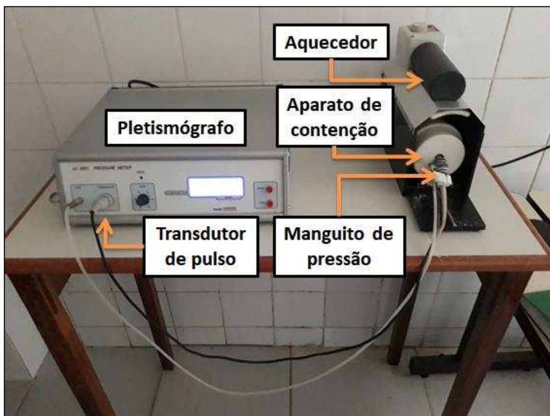
Figura 4. Pletismógrafo utilizado para mensuração da pressão arterial e da frequência cardíaca de repouso.
