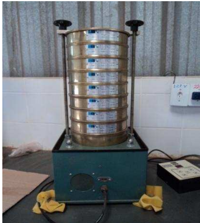
Figura 8 – Agitador eletromagnético equipado com peneiras de malhas 19,10; 9,52; 4,76; 2,38; 1,19; 0,59; 0,29; 0,14 e < 0,14 mm, usado para determinação dos valores de diâmetro médio ponderado dos agregados do solo.
