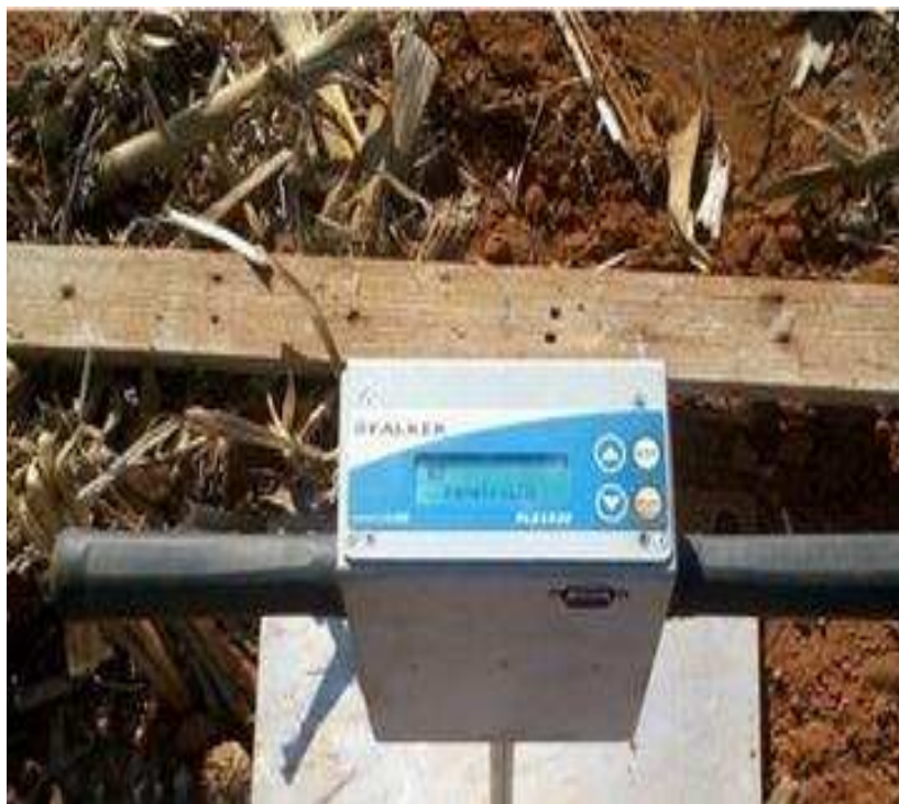
Figura7 – Penetrômetro eletrônico marca FALKER, modelo PenetroLOG PLG 1020.
